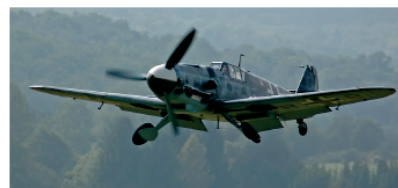
離陸する Bf 109G-6。 カウリング上の MG131 と翼上部の巨大なタイ ヤのふくらみがよくわ かる。操縦士たちは G-6 を「The Bump」と呼ん だ。
