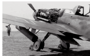
Wfr.Gr.21 ロケット・ランチャーを装備したBf 109G-6R2。
